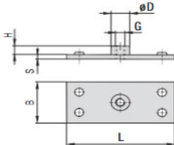
**Schweißplatte mit Gewinde zum befestigen der Doppel-Schelle**
